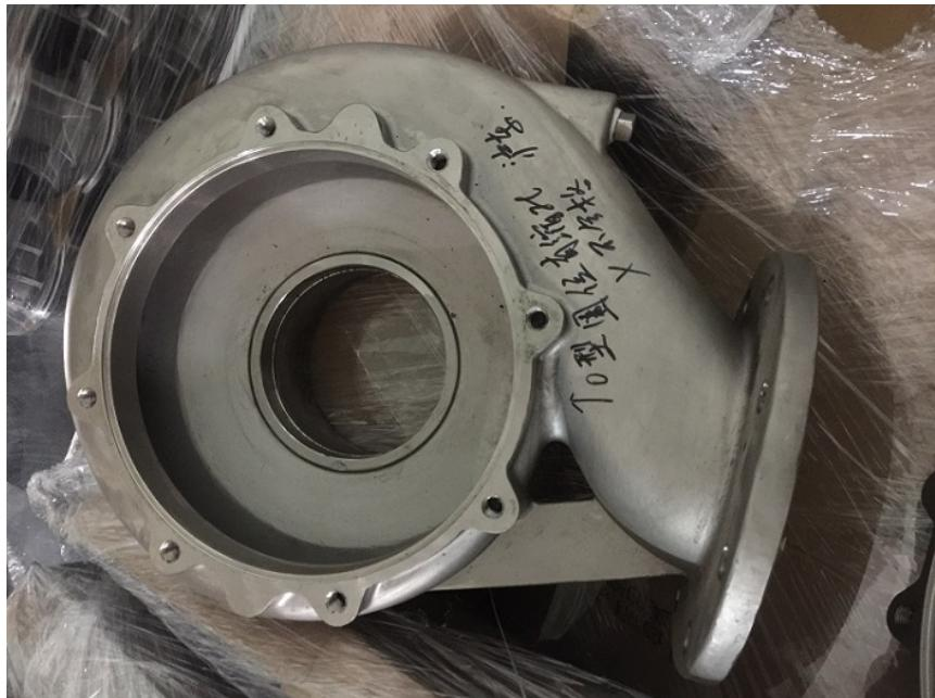
各类铸件的浸渗最主要的功效是密封防漏，以使它能用于液压系统和燃气系统中。例如汽车变速箱体、燃油泵、液压阀、化油器、油缸、水泵、转向助力器、刹车泵、压缩机和液压部件、密闭的飞机仪器及其电子仪器护罩、气动零件和各种气动仪表等。
