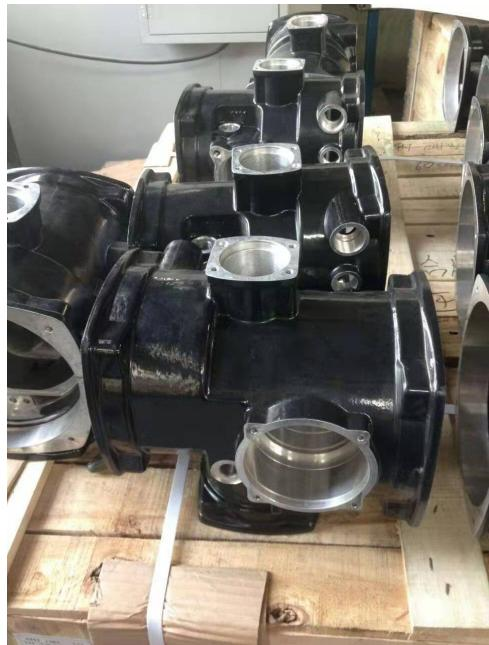
浸渗加工上海昶炫实业有限公司采用标准化浸渗封孔技术，为您提高品质、快速的浸渗封孔代加工处理，解决由于内部微孔或表面缺点而带来的金属铸件和粉末冶金制品的质量问题，包括：1. 金属铸件浸渗封孔（解决泄露问题）2. 粉末冶金制品树脂封孔（解决电镀不良、泄露、腐蚀问题）3. 多孔性材料的改性处理（导电性、物性、耐性改良等）工艺：真空浸渍——离心甩干——清洗1——清洗2——固化——干燥特点：●标准工艺，各技术参数标准设置，严格监测，浸渗合格率接近\*\*\*●浸渗后工件表面干净整洁，无\*\*\*，无碰伤，不变色，不生锈，不长毛，螺纹孔不残留浸渗剂●处理快捷，交货及时处理对象■粉末冶金制品●各种材质的粉末冶金制品，包括汽车摩托车零部件、机械设备零部件、器械装置零部件、电动工具、齿轮件、皮带轮、异性结构件等。■金属铸件●各种汽车发动机铸件，缸体、缸盖、各种箱体、壳体，汽车空调压缩机件，油泵体、油泵座，进气岐管，水箱，耐压机械器械部件，各种受压气、水、液管及控制阀、仪表件等。●其他多孔性材料（金属、陶瓷、木材等）的表性该性处理。
